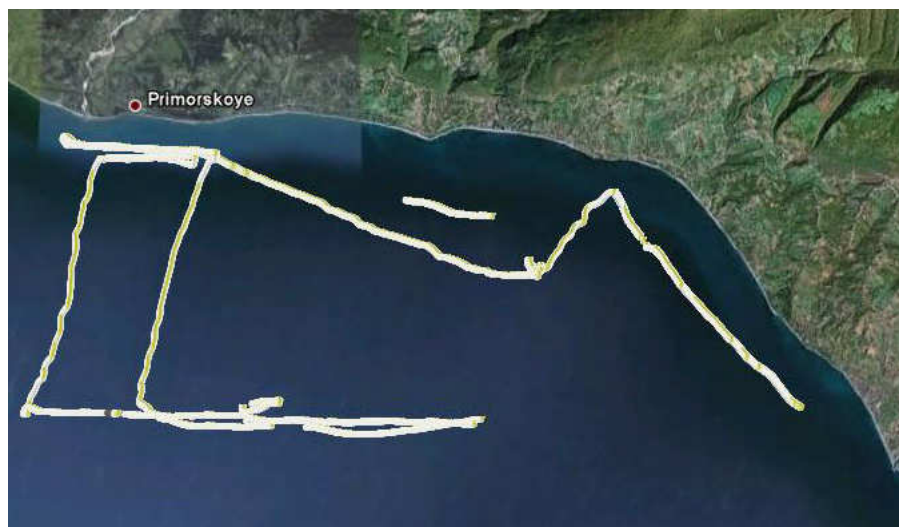
Рисунок 1. Пример отображения в программе GoogleEarth траектории движения носителя при выполнении съемки прибрежной зоны (траектория галсов отображается белым цветом)
