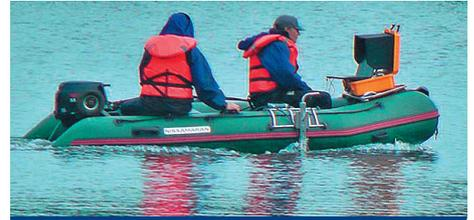
Пример установки локатора на лодке
